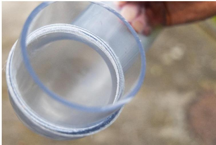
Figure 32 Coude transparent assemblé par soudage. La bavure interne constituant un obstacle à l'écoulement est visible. Ce coude est montré à titre indicatif et n'a pas été utilisé lors des essais.
