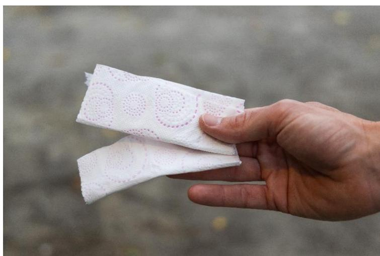
Figure 15 Configuration du papier toilette utilisé lors des essais : 2 ensembles de 3 coupons superposés et repliés en 2 dans le sens de la longueur.
