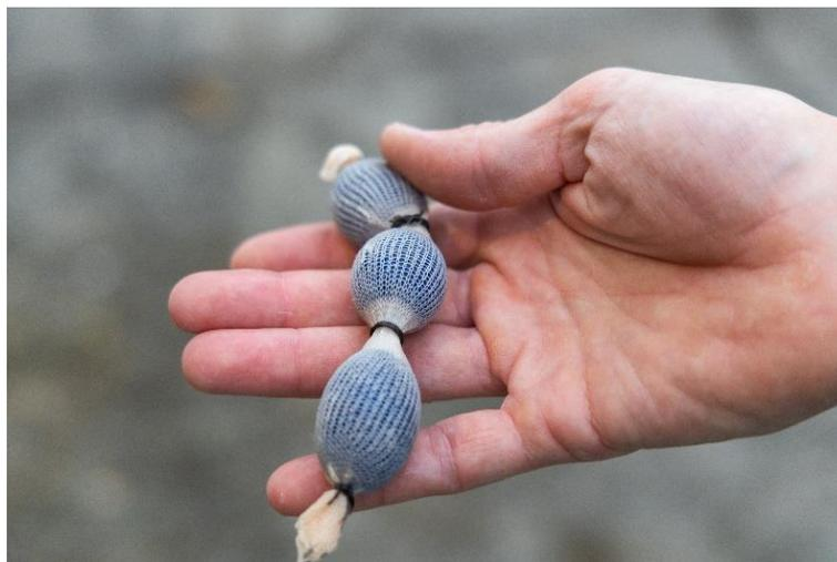
Figure 14 Simulateur de matière fécale ou corps d'épreuve conforme à la norme NBN EN 997. Trois de ces simulateurs sont utilisés lors des évacuations avec matière fécale.
