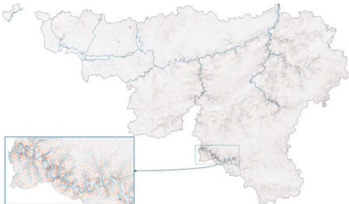
Figure 19 : Carte de l'indice de position topographique (TPI) et des voies navigables de Wallonie (traits bleus). TPI : Soustraction de l'altitude en un endroit donné et de l'altitude moyenne dans un rayon d'un kilomètre autour de cet endroit pondérée par la distance au carré. Plus l'indice est marqué (positivement [rouge] ou négativement [bleu]), plus les hauteurs de chute potentielles sont importantes.
