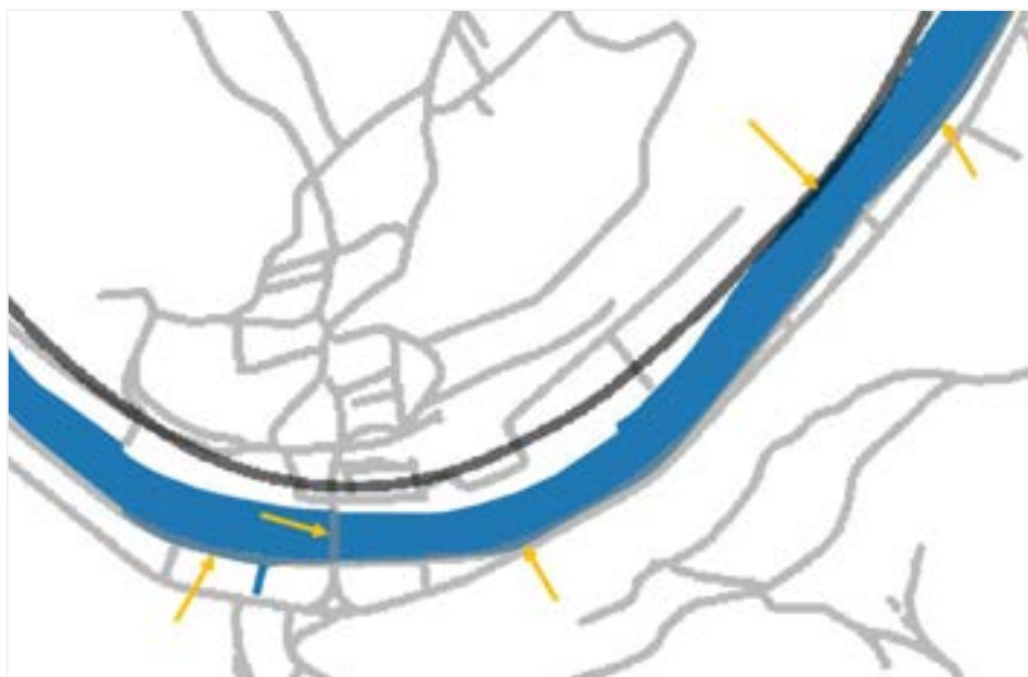
Figure 5 : Exemples du phénomène de rognage par les couches de contraintes sur les zones d'intérêt prioritaire. Rail en noir, Ponts et Chaussées en gris, Voie navigable en bleu (Meuse) et Rognages pointés en orange.
