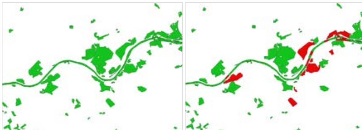
Figure 10 : Illustration des zones blanches filtrées sur base de leur superficie (à gauche en vert) et des zones blanches considérées comme bassin de sites potentiels après analyse combinatoire (à droite en rouge).
